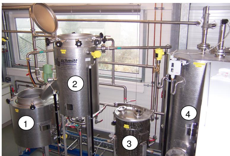
Abb. 11: Pilotanlage im Technikumsmaßstab zum Aufschluss und Fermentation von Biomassen.
