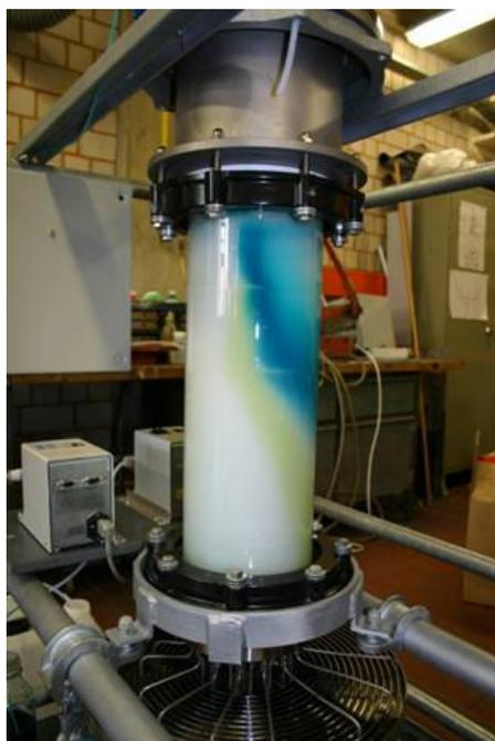
Abb. 9: Kontinuierlicher annularer Chromatograph im Labormaßstab (Technische Universität Kaiserslautern; Arbeitsgruppe Prof. Bart).
